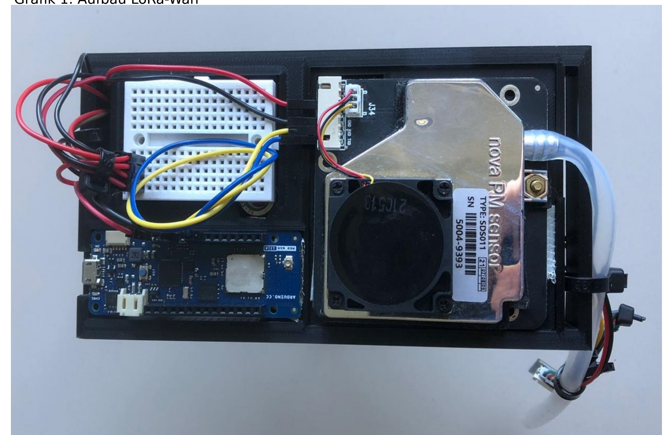
Grafik 2: Basisplatte mit Arduino und Sensoren
