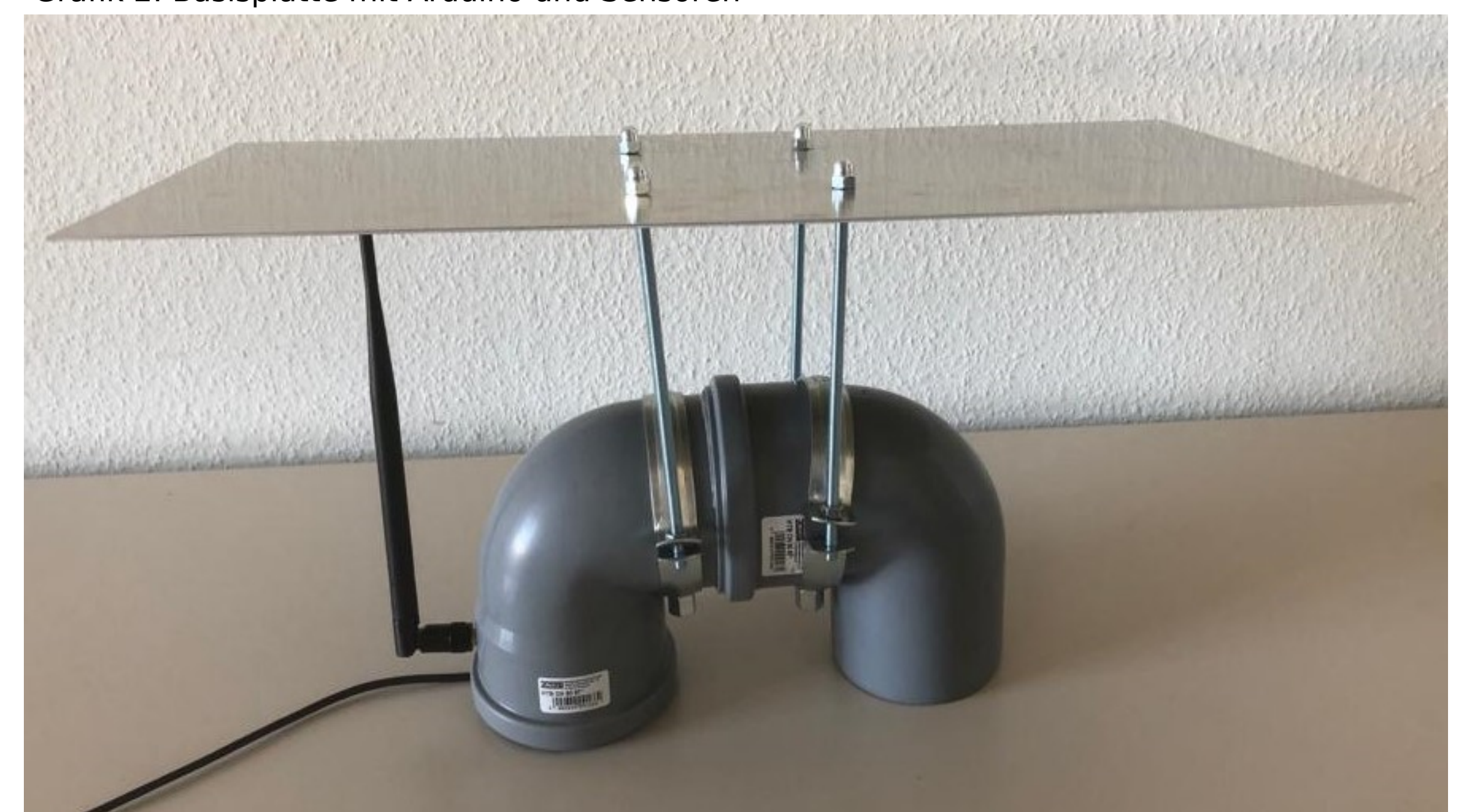
Grafik 3: Gehäuse mit Antenne und Sonnenschutz
